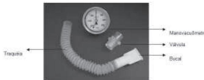
Figura 3 – Foto do manovacuômetro da marca GERAR®.
