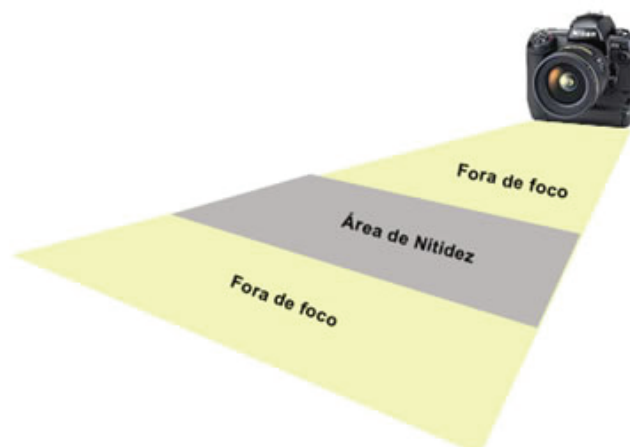
Figura 9: Representação da propriedade de profundidade de campo em fotográfica. Fonte: Jorge Marmion, Sampa Online (2008).
