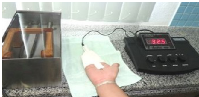
Figura 3: Posicionamento do termômetro para o teste de aplicação de calor convectivo (imersão).
